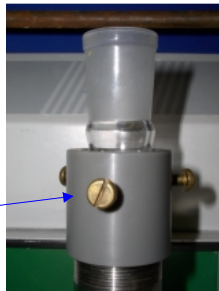
Bild 3b: Detailaufnahme der Verschraubung am Ende des Edelstahlrohres
