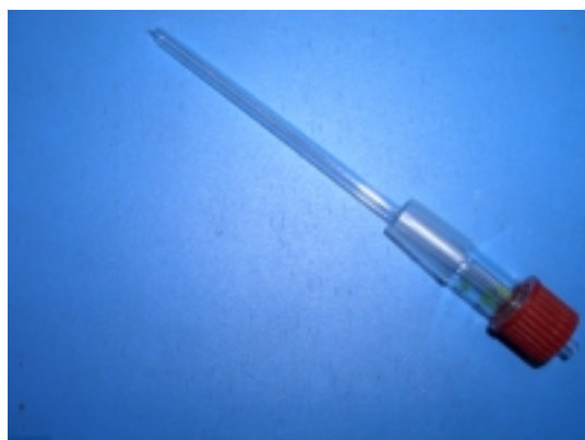
Bild 4c: Gewinderohr mit Glasschutzrohr
