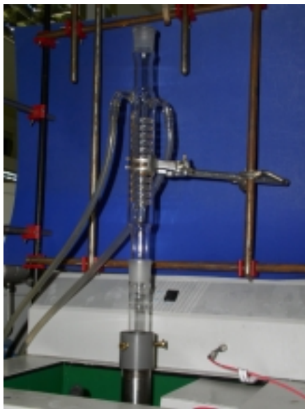
Bild 5: Aufsetzen des Rückflusskühlers
