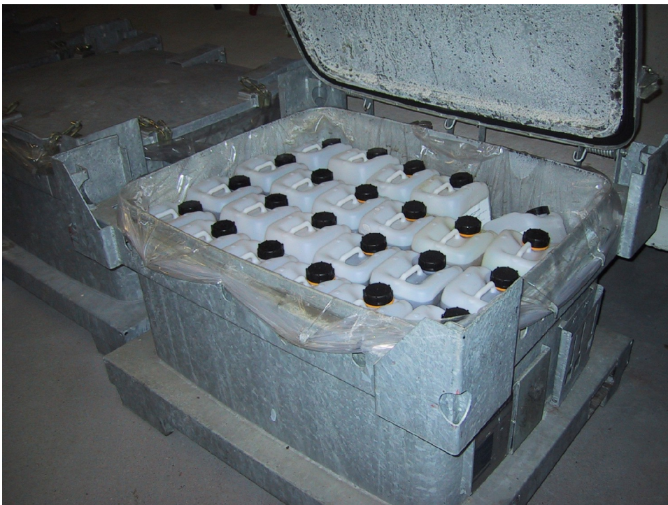
Bild 3: ASP-Container in geöffnetem Zustand mit eingelagerten Sammelkanistern.
