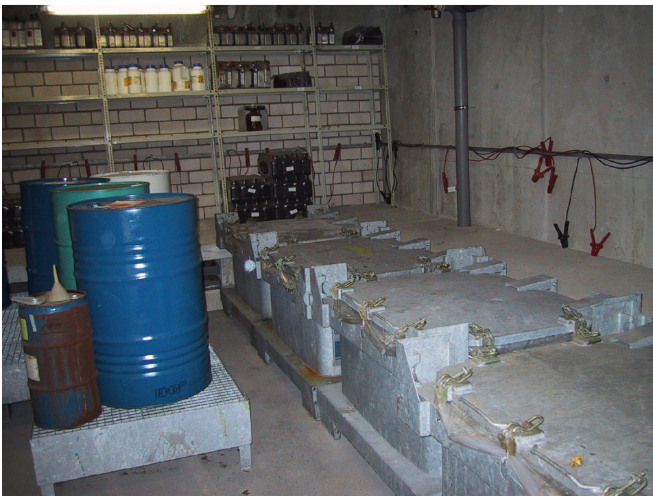
Bild 2: Blick auf vier ASP-Container in geschlossenem Zustand für die Lagerung und den Transport der Abfälle.
