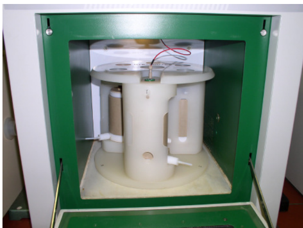
Fig. 14: Sistema di estrazione-filtrazione a caldo HEF 270 nel forno a micro-onde ETHOS 1600; tutto è pronto per iniziare l'estrazione
