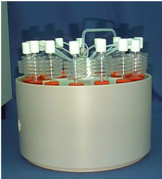
При использовании этих реакторных систем можно проводить эксперименты, требующие обратного кипячения, в масштабе от 1 до 10 ммоль. Охлаждение лучше осуществлять путем вентиляции внутри микроволновой системы или путем отдельной
