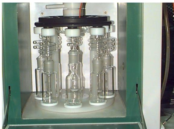
**Фото 3в:** Вращающееся устройство для кипячения с обратным холодильником на 15 реакторов для групповых экспериментов или параллельных синтезов
