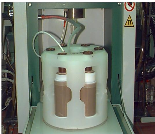
**Фото 4б:** Реактор высокого давления на 36 отделений
