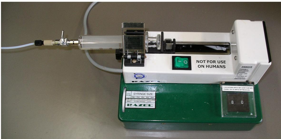
Spritzenpumpen liefern einen sehr konstanten und pulsationsfreien Fluss, je nach Spritzendurchmesser sind bis zu etwa 5 bar Gegendruck erreichbar. Einfache Spritzenpumpen lassen keinen kontinuierlichen Betrieb des Reaktors zu, die Laufzeiten werden durch das Spritzenvolumen und die Flussrate begrenzt. Für den Einsatz im Praktikum oder in der Forschung ist diese Einschränkung weniger wichtig.
