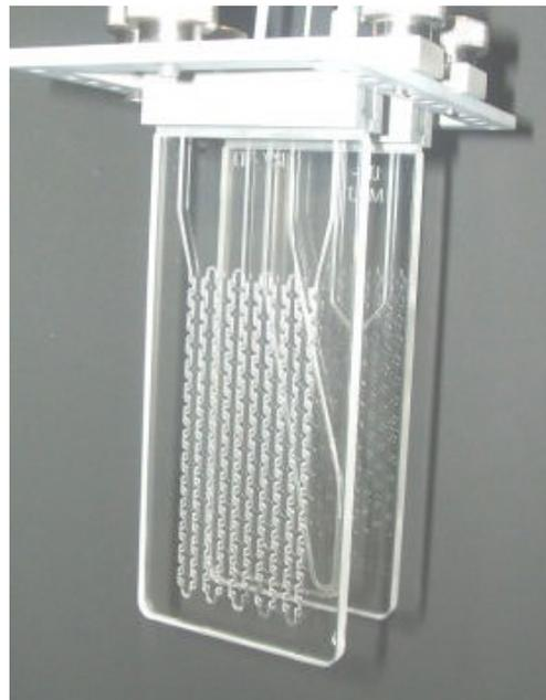
Die Temperierung der Reaktoren erfolgt im einfachsten Fall durch Eintauchen in ein Becherglas mit Öl oder Wasser. Selbstverständlich können auch vorhandene Badthermostaten verwendet werden.
