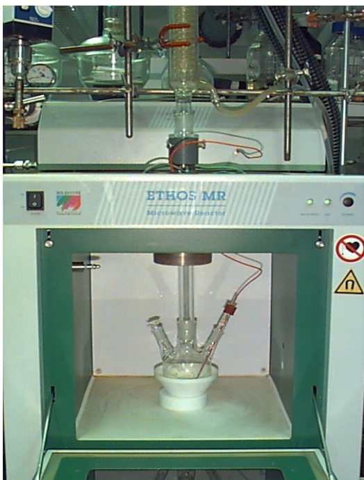
Bild 2: Mikrowellensystem ETHOS MR mit Rückflussapparatur (Temperaturmessung mit faseroptischem Sensor)
