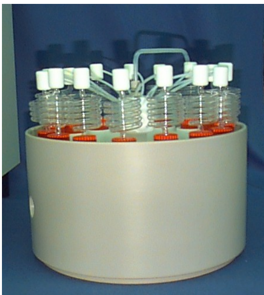
Bild 3c: 15-fach-Rückflussrotor für Gruppen-Versuche oder Parallelsynthese
