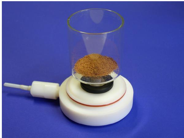
Das zu extrahierende Material (in Bild 4 Muskatnusspulver) wird abgewogen und mit 40 ml Extraktionsmittel (hier Ethanol) in das Glasinnengefäß gegeben. Zur besseren Vermischung ist der Einsatz eines Magnetrührers im Extraktionsgefäß möglich, welcher in das Glasinnengefäß gegeben wird.
