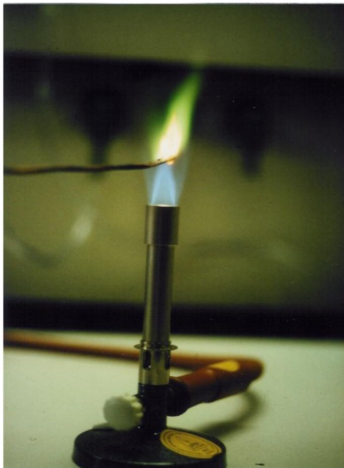
**Abbildung 1:** Durchführung der Beilsteinprobe auf Halogene
