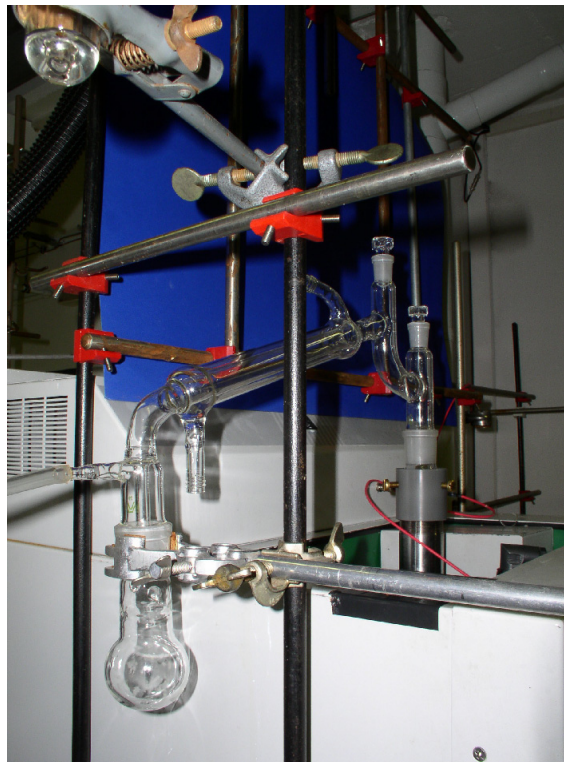
Рисунок 2: Насадка для перегонки, соединенная со стеклянной соединительной трубкой
